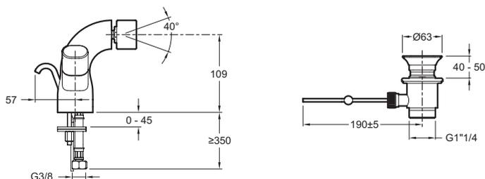
Спецификация продукта: Смеситель для биде и донным клапаном. E10088RU. Коллекция: TALAN. Вес: 2 кг. Расход воды: 12 л/мин при давлении 3 бар. Подключение: С гибкой подводкой. Механизм: Кран-буксы с керамическим диском. Скрытый вращающийся аэратор с антиизвестковым покрытием.
