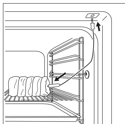
2. Вставте штекер термощупа у гніздо спереду на приладі. На дисплеї мигтітиме символ термощупа .
