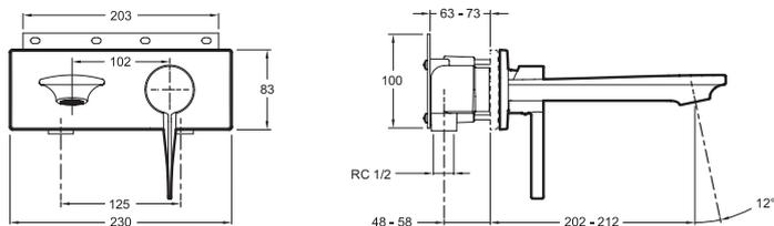
Спецификация продукта: Встраиваемый однорычажный настенный смеситель для раковины. E9106. Коллекция: STANCE. Вес: 4,9 кг. Расход воды: 5 л/мин. Скрытый аэратор с антиизвестковым покрытием.
