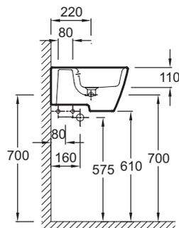
Спецификация продукта: угловой раковина 36.5 x 36.5 см с заглушкой для переливного отверстия. E1566. Коллекция: OVE. РАЗМЕРЫ (СМ): 36,50 x 36,50 см. ВЕС: 12,8 кг. РАЗМЕТКА СВЕРЛЕНИЯ ОТВЕРСТИЯ ДЛЯ СМЕСИТЕЛЯ: С 1 отверстием для смесителя. КРЕПЕЖИ: 2 шпильки для крепежа (в комплект не входит). ОТВЕРСТИЯ ДЛЯ СВЕРЛЕНИЯ: С 1 отверстием для смесителя. УСТАНОВКА: Компактные. ОТВЕРСТИЕ ПЕРЕЛИВА: С отверстием перелива. ПРОДУКТ В КОМПЛЕКТЕ: (смеситель заказывается отдельно). Полупьедестал.
